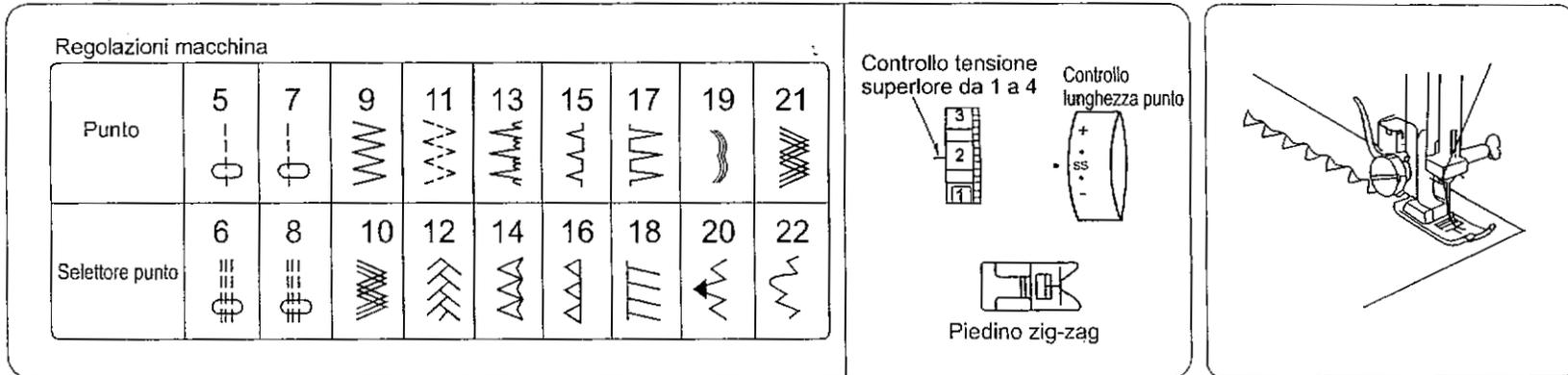
Quando il trasporto avanti e indietro risulta non bilanciato a causa del tipo di tessuto, correggete il bilanciamento ruotando il controllo lunghezza punto nel modo seguente:
