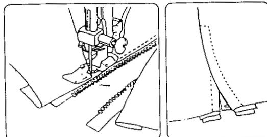
Spillare o imbastire la cerniera al capo e posizionarla sotto il piedino. Portare i fili verso il retro e abbassare il piedino. Per cucire il lato sinistro della cerniera, accompagnare il bordo della cerniera lungo i denti cucendo il nastro della cerniera al capo. Ruotare il capo e cucire l'altro lato della cerniera procedendo allo stesso modo.
