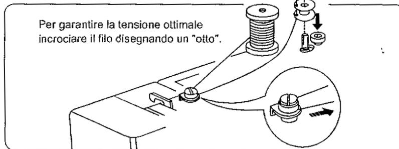
Prelevare il filo dal rocchetto. Farlo passare nella guida del filo dell'avvolgitore della bobina. Inserire il filo in uno dei fori della bobina dall'interno all'esterno.
