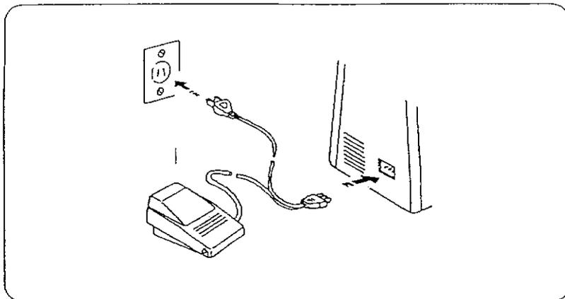
Prima di collegare la macchina alla presa di alimentazione, assicurarsi che il voltaggio e la frequenza dell'alimentazione elettrica siano conformi a quelli della macchina.
