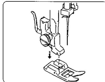
Sistemare il piedino in modo che sia situato esattamente sotto l'apertura del supporto del piedino. Abbassare il supporto per fissare il piedino.
