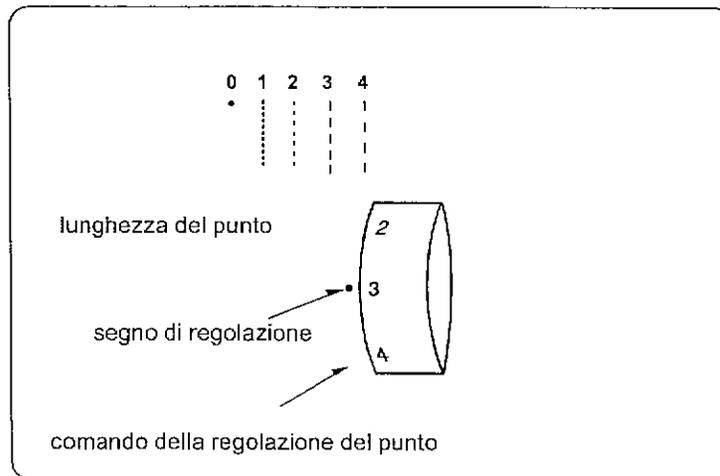
Questo comando regola la lunghezza del punto ed è dotato anche di una regolazione per i punti stretch.
