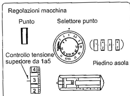
Eseguite un'asola di prova ed un campione con uguale tessuto, stabilizzatore e cucitura del capo che state realizzando. Posizionate il bottone sul campione di tessuto e segnate inizio e fine per determinare la lunghezza dell'asola.
