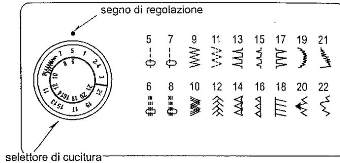
Il selettore di cucitura non determina solo il punto scelto, ma regola anche la sua larghezza per punti zig-zag e smerlo stretch.
