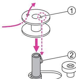
4. Inserire il capo del filo all'interno del foro laterale della spolina come mostrato in figura a fianco. Inserire la spolina vuota all'interno del perno avvolgi spolina facendo in modo che il suo incavo sia allineato alla molla del perno stesso.
