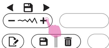
Premendo ripetutamente il tasto selezione memoria " + " oppure " - " il display LCD avanza visualizzando uno per uno ogni unità di sequenza precedentemente salvata e memorizzata.
