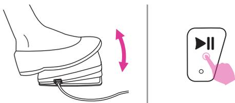
7. Pigiare delicatamente il reostato oppure premere il tasto start/stop per iniziare a cucire. Rilasciare il reostato oppure premere il tasto start/stop per fermare la macchina.
