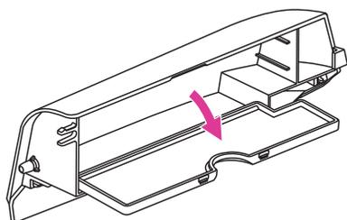
La parte anteriore dell'allunga base viene utilizzata per riporre gli accessori forniti in dotazione. Per aprire lo sportellino del vano tirarlo in basso.
