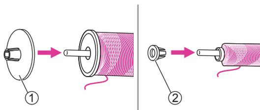
1. Posizionare il rocchetto di filo ed il ferma spola all'interno del porta spola orizzontale. Scegliere il ferma spola (grande o piccolo) in base al diametro del rocchetto di filo spingendolo contro il rocchetto fino a farlo aderire ad esso.
