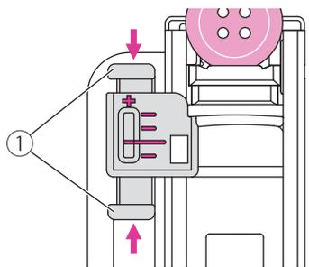
Considerando che ogni bottone ha diametro e spessore unici attraverso la leva bilanciamento asola è possibile regolare la chiusura dell'asola in caso di chiusura anticipata o posticipata di una delle due travette su tessuti particolari. Il tasto regolazione asola invece permette di stabilire lo spessore di ciascuna travetta mantenendo invariata la distanza fra loro; di conseguenza lo spazio all'interno dell'asola aumenta oppure diminuisce
