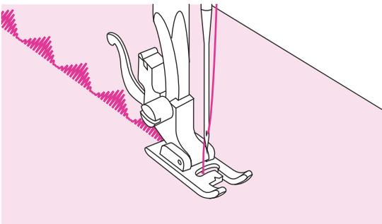
Il piedino è dotato di due scanalature nella parte inferiore che consentono di cucire con facilità e di scivolare lungo lo spessore dei punti. In questo modo il tessuto viene trasportato uniformemente durante la cucitura.
