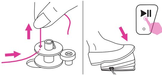
6. Trattenere il capo del filo fra indice e pollice. Avviare la macchina premendo il reostato oppure attraverso il tasto start/stop.
