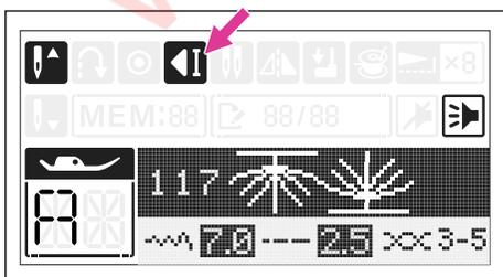
Quando la macchina sta cucendo: impostando i punti a selezione diretta da 6 a 9 oppure del gruppo 000 da 001 a 009 e da 027 a 128 premendo il tasto nodo automatico, la macchina completa la sequenza disegno in corso, esegue 3 punti sulla stessa battuta d'ago per poi fermarsi automaticamente. Se si preme nuovamente il tasto mentre la macchina è in corsa, la funzione viene annullata.
