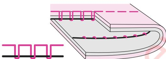
Quando il filo superiore è visibile sul rovescio del tessuto, portare il selettore della tensione su un numero più alto per stringere la tensione.
