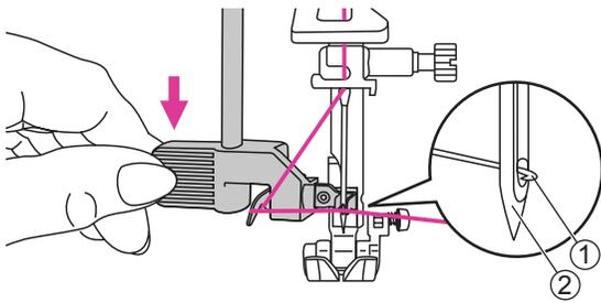
12. L'uncino girando si posiziona davanti la cruna dell'ago e subito dopo si inserisce al suo interno per predisporre l'infilatura automatica.
