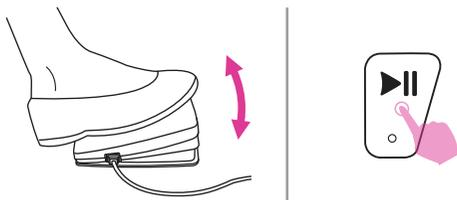
7. Pigiare delicatamente il reostato oppure premere il tasto start/stop per iniziare a cucire. Rilasciare il reostato oppure premere il tasto start/stop per fermare la macchina.
