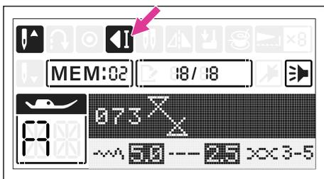
Premendo nuovamente il tasto marcia indietro la funzione viene disattivata: la macchina esegue 3 punti sulla stessa battuta d'ago alla fine della combinazione. Il display LCD mostra l'icona auto-stop durante la cucitura dell'ultimo punto in sequenza.
