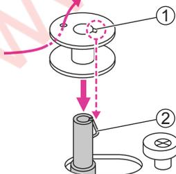
4. Inserire il capo del filo all'interno del foro laterale della spolina come mostrato in figura a fianco. Inserire la spolina vuota all'interno del perno avvolgi spolina facendo in modo che il suo incavo sia allineato alla molla del perno stesso.
