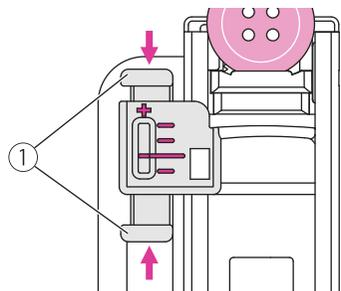
Considerando che ogni bottone ha diametro e spessore unici attraverso la leva bilanciamento asola è possibile regolare la chiusura dell'asola in caso di chiusura anticipata o posticipata di una delle due travette su tessuti particolari. Il tasto regolazione asola invece permette di stabilire lo spessore di ciascuna travetta mantenendo invariata la distanza fra loro; di conseguenza lo spazio all'interno dell'asola aumenta oppure diminuisce (riferimento pagina 26).
