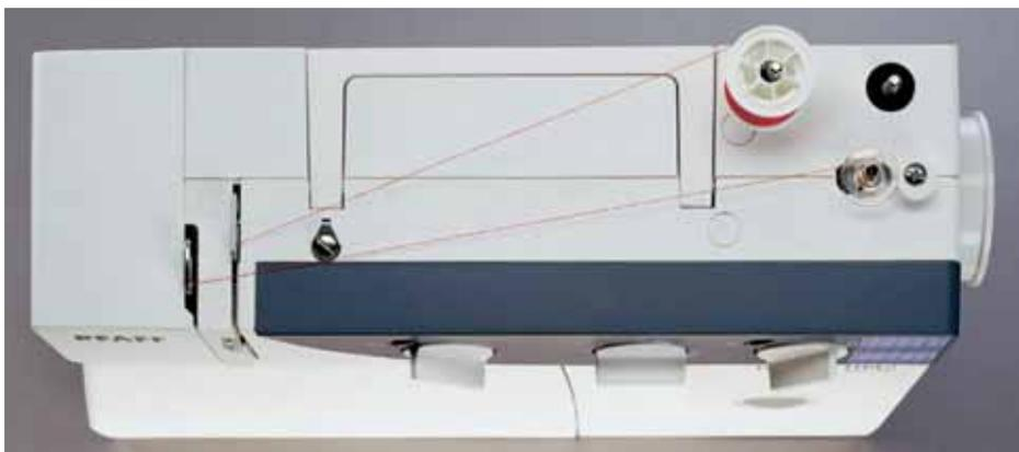
Far passare quindi il filo attraverso la fessura sinistra (18) e portarlo verso l'alto. Posarlo sulla leva tendifilo (28) da sinistra a destra. Avvolgerlo quindi più volte attorno alla spolina, in senso orario. Infine, tenendo fermo il capo del filo, portare lo spolatore a destra, sbloccare il volantino a premere sul pedale.
