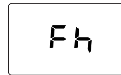
fig. 7- Purga de aire con ventilador apagado
