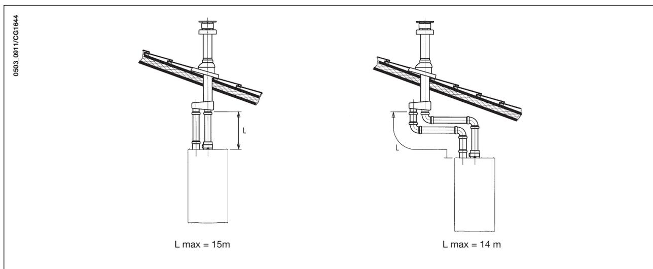
**IMPORTANTE:** il condotto singolo per scarico combusti deve essere opportunamente coibentato, nei punti dove lo stesso viene in contatto con le pareti dell'abitazione, con un adeguato isolamento (esempio materassino in lana di vetro). Per istruzioni più dettagliate sulle modalità di montaggio degli accessori vedere le notizie tecniche che accompagnano gli accessori stessi.
