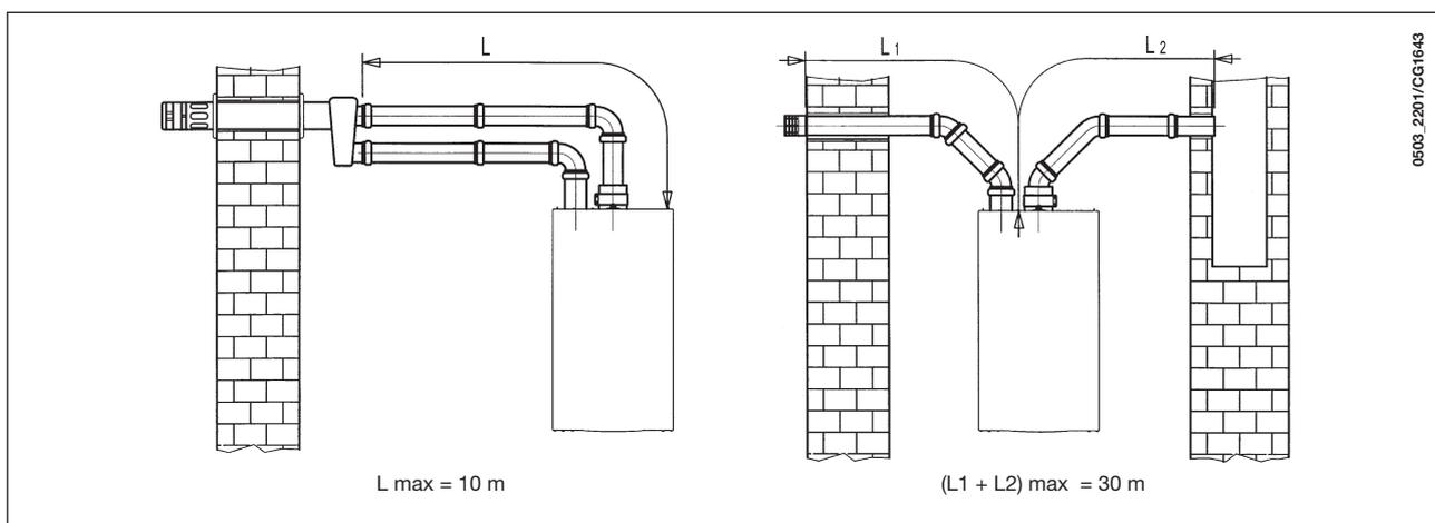
**NB:** Per la tipologia C52 i terminali per l'aspirazione dell'aria comburente e per l'evacuazione dei prodotti della combustione non devono essere previsti su muri opposti all'edificio.
