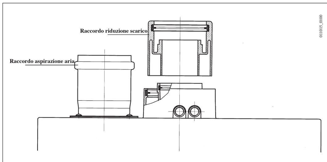
La curva a 90° permette di collegare la caldaia ai condotti di scarico e di aspirazione in qualsiasi direzione grazie alla possibilità di rotazione a 360°. Essa può essere utilizzata anche come curva supplementare in abbinamento al condotto o alla curva a 45°.
