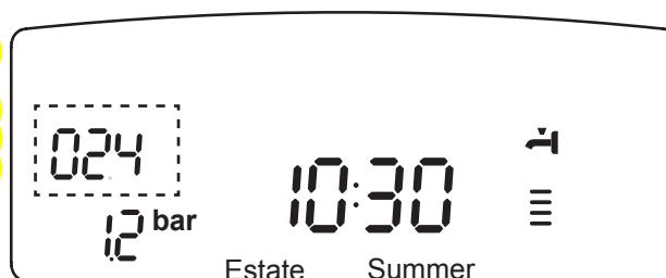
La modalità di funzionamento verrà visualizzata dalle tre cifre evidenziate nel disegno sopra riportato:
