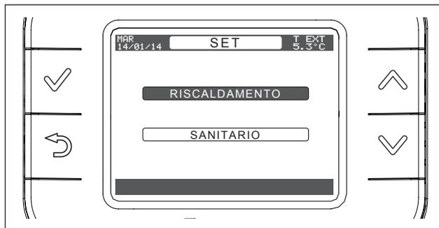
Se è collegata la sonda esterna il SET del RISCALDAMENTO imposta la temperatura di riferimento per le curve climatiche  $Tr=20+SET\ RISC\ (-5 \dots 5)$
