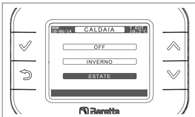
È attiva la funzione di solo acqua calda sanitaria. La caldaia è in uno stato di stand-by fino a quando, a seguito di una richiesta di calore dal bollitore, il bruciatore si accende
