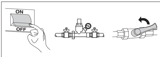
**⚠** Svuotare gli impianti se c'è rischio di gelo. Se disponibile, utilizzare dell'aria compressa per facilitare lo svuotamento del circuito sanitario o in alternativa contattare il Centro Tecnico di Assistenza.
