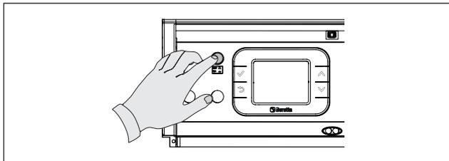
In caso di rischio gelo, per mantenere attive le funzioni di antigelo automatico, mantenere il quadro elettrico alimentato lasciando l'interruttore generale dell'impianto attivo. Se ciò non fosse possibile, posizionare l'interruttore generale dell'impianto su "spento" (OFF), chiudere i rubinetti del combustibile, dell'impianto termico e sanitario. In questo caso le funzioni antigelo sono disattivate.
