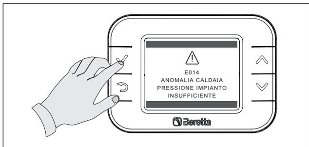
A questo punto la caldaia ripartirà automaticamente. Se la causa dell'errore non è stata eliminata, dopo alcuni tentativi di sblocco, la caldaia potrebbe andare in blocco permanente (per ulteriori informazioni interpellare il Centro Tecnico di Assistenza).
