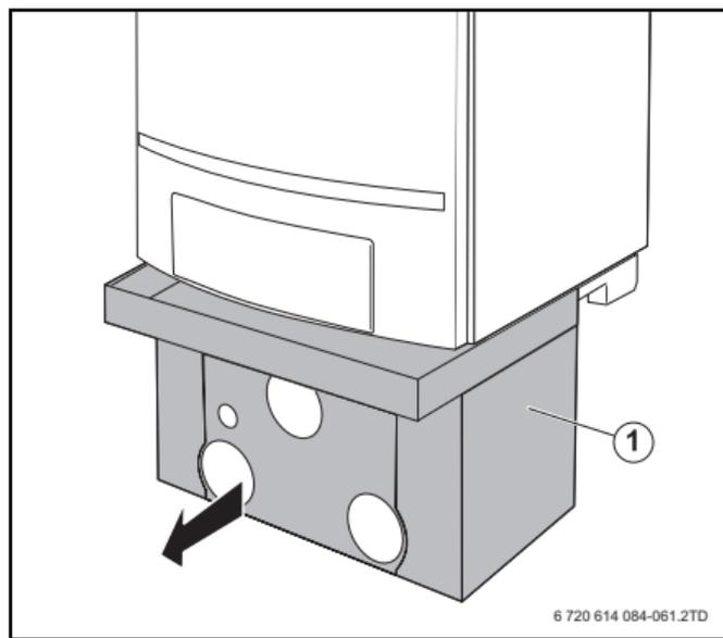
Fig. 1 Rivestimento del gruppo di collegamento (accessorio)
