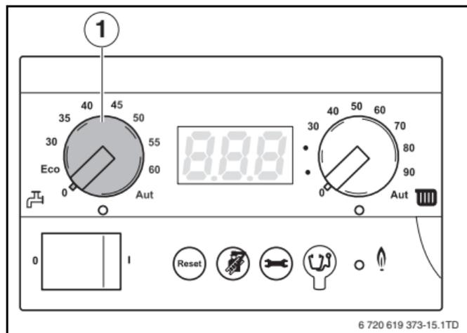
Fig. 9 BC10 Manopola per «valore nominale dell'acqua calda sanitaria»
