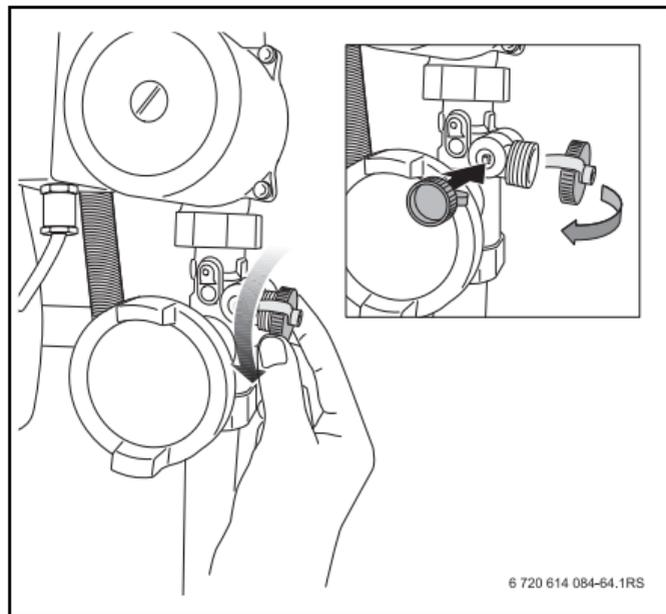
Fig. 3 Tappo di chiusura rubinetto di carico e scarico
