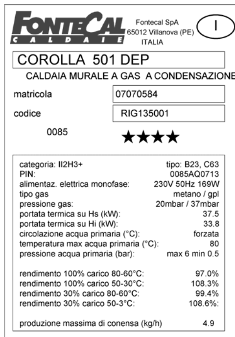
Figura 5: esempio di targhetta identificativa del prodotto
