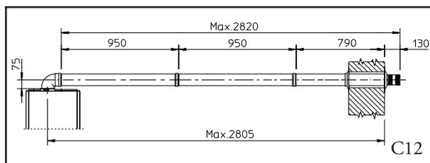
Collegamento con N°2 prolunghe. Max. distanza fra asse verticale caldaia e parete esterna mm 2805.
