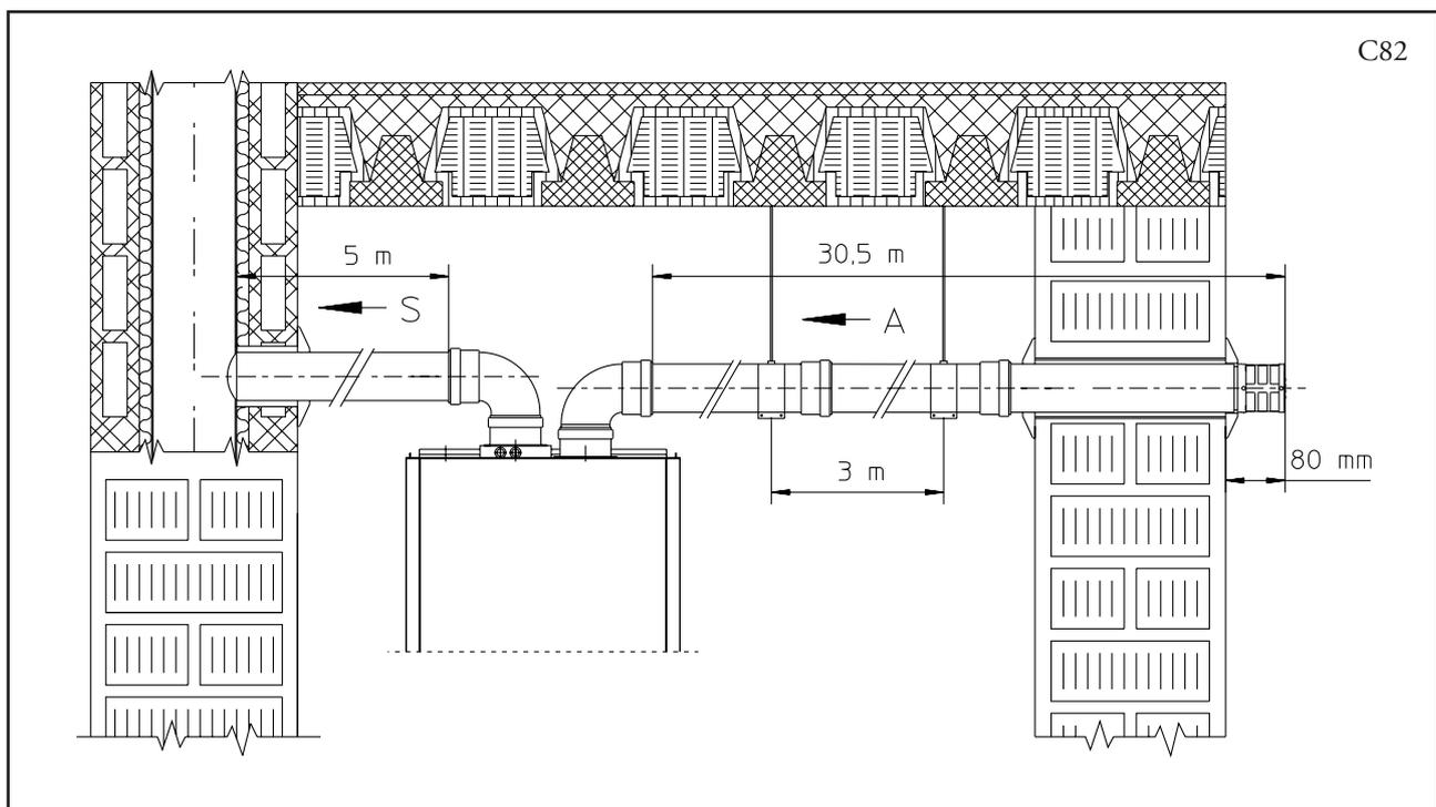
**N.B.:** durante l'installazione dei condotti Ø 80 è necessario installare ogni 3 metri una fascetta rompitratta con tassello.
