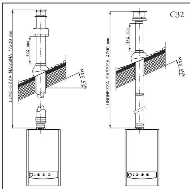
**Kit separatore Ø 80/80.** Il kit separatore Ø 80/80, consente di separare i condotti di scarico fumi e aspirazione aria secondo lo schema riportato in figura. Dal condotto (B) vengono espulsi i prodotti della combustione. Dal condotto (A) viene aspirata l'aria necessaria per la combustione. Il condotto di aspirazione (A) può essere installato indifferentemente a destra o sinistra rispetto al condotto centrale di scarico (B). Entrambi i condotti possono essere orientati in qualsiasi direzione.
