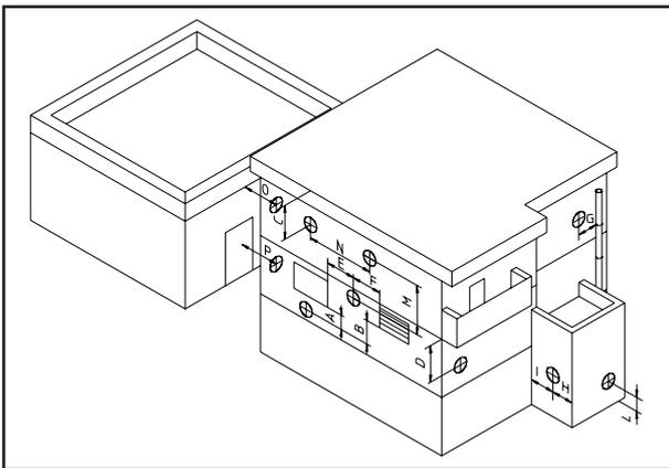
**Scarico dei prodotti della combustione di apparecchi a tiraggio forzato entro spazi chiusi a cielo libero.** Negli spazi a cielo libero chiusi su tutti i lati (pozzi di ventilazione, cavedi, cortili e simili), è consentito lo scarico diretto dei prodotti della combustione di apparecchi a gas a tiraggio naturale o forzato e portata termica oltre 4 e fino a 35 kW, purché siano rispettate le condizioni di cui alla normativa tecnica vigente (UNI 7129:2001 par. 5.7).
