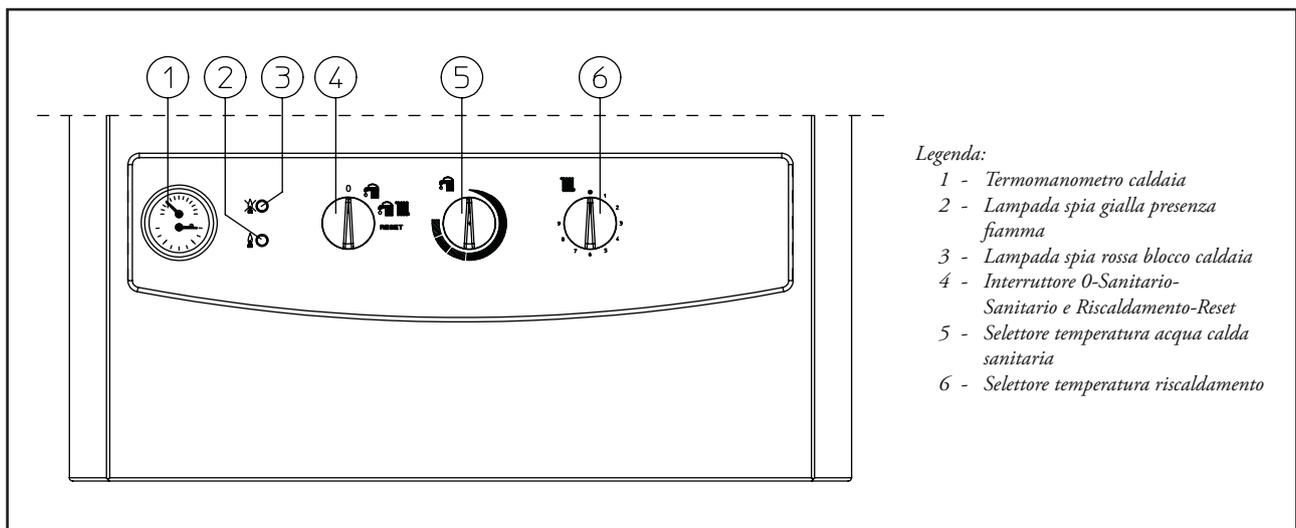
**Accensione della caldaia.** Prima dell'accensione verificare che l'impianto sia pieno d'acqua controllando che la lancetta del manometro (1) indichi un valore compreso fra 1 ÷ 1,2 bar.
