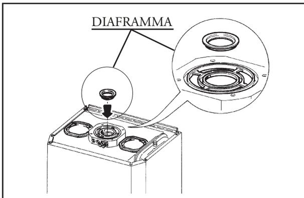
**N.B.:** i diaframmi vengono forniti di serie unitamente alla caldaia.
