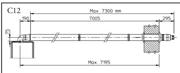
**N.B.:** durante l'installazione dei condotti è necessario installare ogni 3 metri una fascetta rompitratta con tassello.
