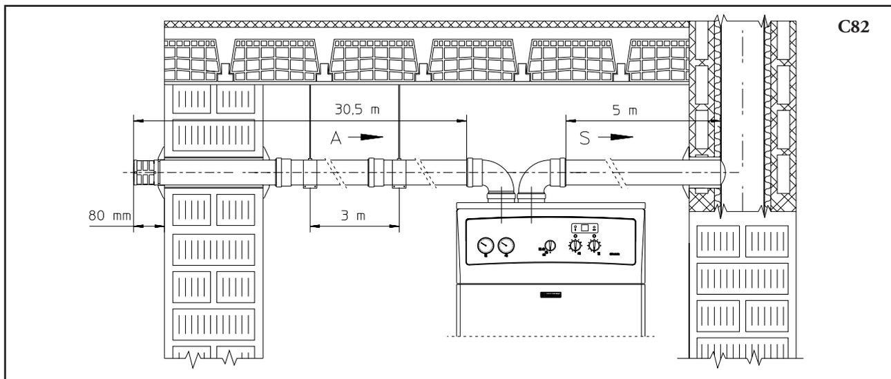
**N.B.:** Durante l'installazione dei condotti Ø 80 è necessario installare ogni 3 metri una fascetta rompitratta con tassello.
