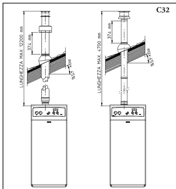
**Kit separatore Ø 80/80.** Il kit separatore Ø 80/80, consente di separare i condotti di scarico fumi e aspirazione aria secondo lo schema riportato in figura. Dal condotto (B) vengono espulsi i prodotti della combustione. Dal condotto (A) viene aspirata l'aria necessaria per la combustione. Entrambi i condotti possono essere orientati in qualsiasi direzione.
