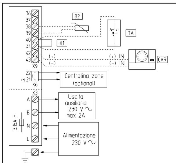
rispettando la polarità L-N ed il collegamento di terra (⊕), su tale rete deve essere prevista una disconnessione onnipolare che assicuri una distanza di apertura dei contatti di almeno 3,5 mm. In caso di sostituzione del cavo di alimentazione rivolgersi ad un tecnico abilitato (ad esempio il Servizio Assistenza Tecnica Autorizzato Immergas). Il cavo di alimentazione deve rispettare il percorso prescritto come da figura.
