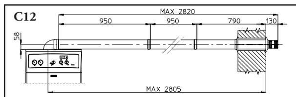
Collegamento con N°2 prolunghie. Distanza fra asse verticale caldaia e parete esterna mm 2805.
