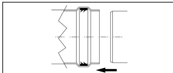
**Installazione diaframma.** Per un corretto funzionamento della caldaia è necessario installare sull'uscita della camera stagna e prima del condotto di aspirazione e scarico un diaframma (vedi figura). La scelta del diaframma appropriato avviene in base al tipo di condotto e alla sua massima estensione: detto calcolo si può effettuare con l'utilizzo delle tabelle:
