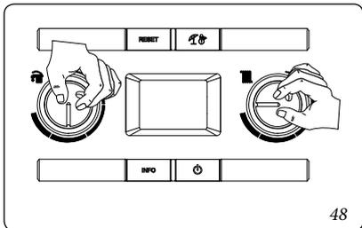
Una volta entrati in programmazione è possibile scorrere attraverso i cinque menù (G, P, t, A, F) premendo il pulsante "Estate / Inverno" per 1 secondo.
