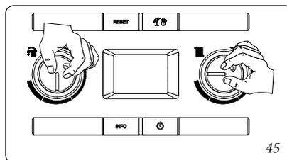
Attivata la funzione la caldaia effettua in sequenza le operazioni necessarie per tarare l'apparecchio alla potenza nominale, intermedia e minima.
