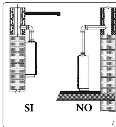
**Attenzione:** l'installazione della caldaia sulla parete, deve garantire un sostegno stabile ed efficace al generatore stesso.
