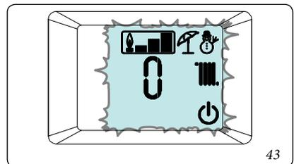
Solo dopo il lampeggio della cornice presenza fiamma è possibile correggere il rapporto aria - gas (Parag. 3.10) oppure uscire dalla fase di taratura premendo il pulsante "estate / inverno".
