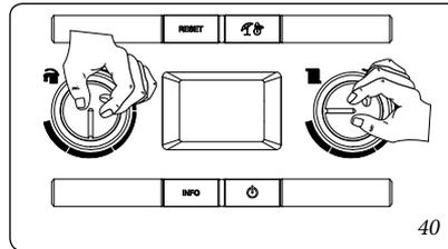
• **Potenza nominale:** attivata la funzione la caldaia effettua le operazioni necessarie per tarare l'apparecchio alla potenza nominale.
