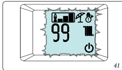
Solo dopo il lampeggio della cornice presenza fiamma è possibile correggere il rapporto aria - gas (Parag. 3.10) oppure passare alla potenza successiva premendo il pulsante "info".
