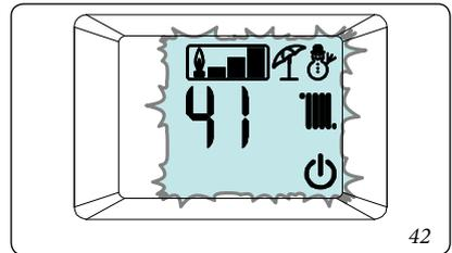
Solo dopo il lampeggio della cornice presenza fiamma è possibile correggere il rapporto aria - gas (Parag. 3.10) oppure passare alla potenza successiva premendo il pulsante "info".
