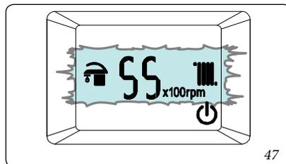
L'apparecchio resta in questa modalità per un tempo massimo di 15 minuti mantenendo costante la velocità del ventilatore.
