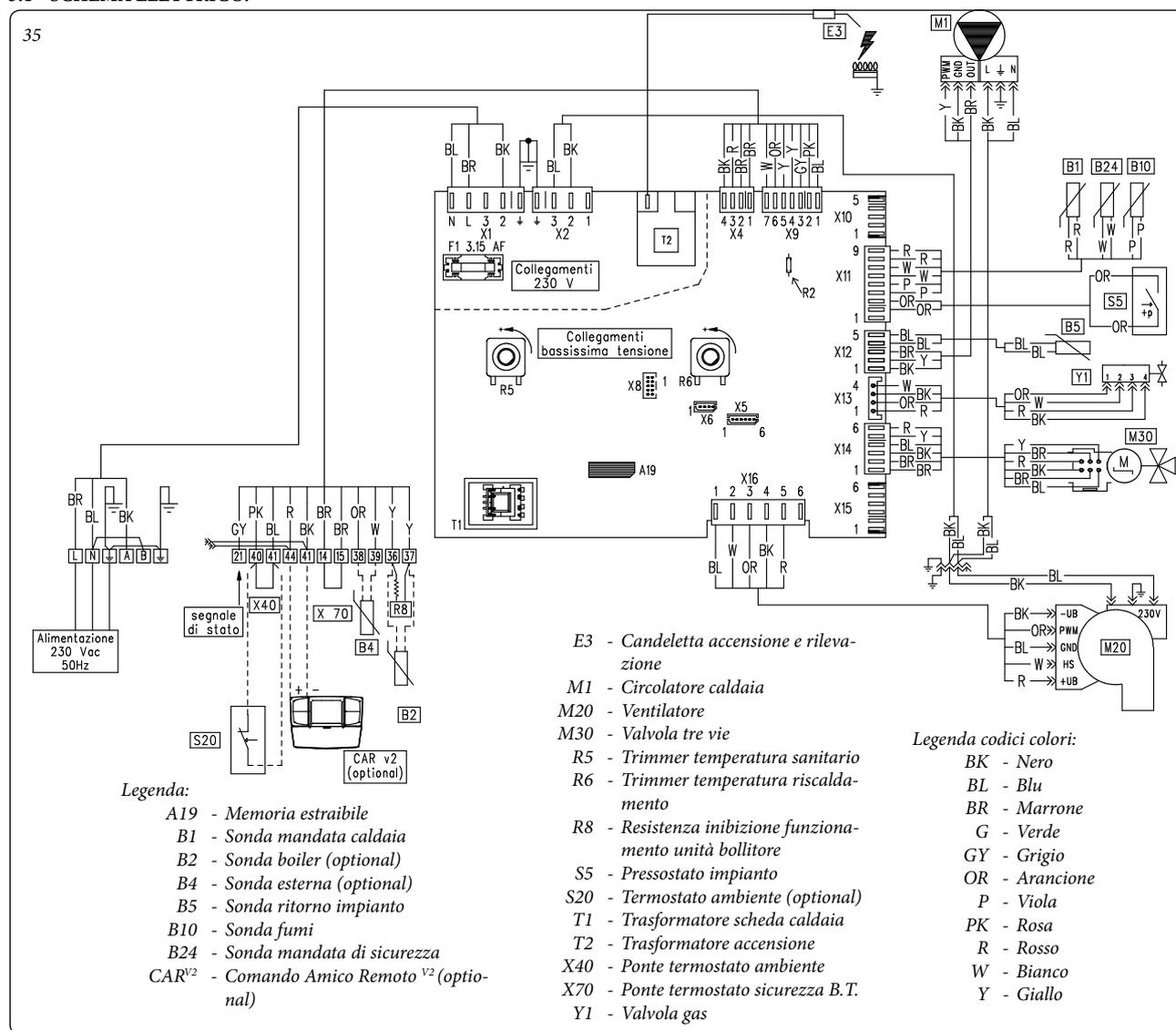
Unità bollitore: la caldaia è predisposta per il collegamento ad un'unità bollitore, la quale deve essere collegata ai morsetti 36 - 37 della morsettieria (posta all'interno del vano allacciamenti) eliminando la resistenza R8.
