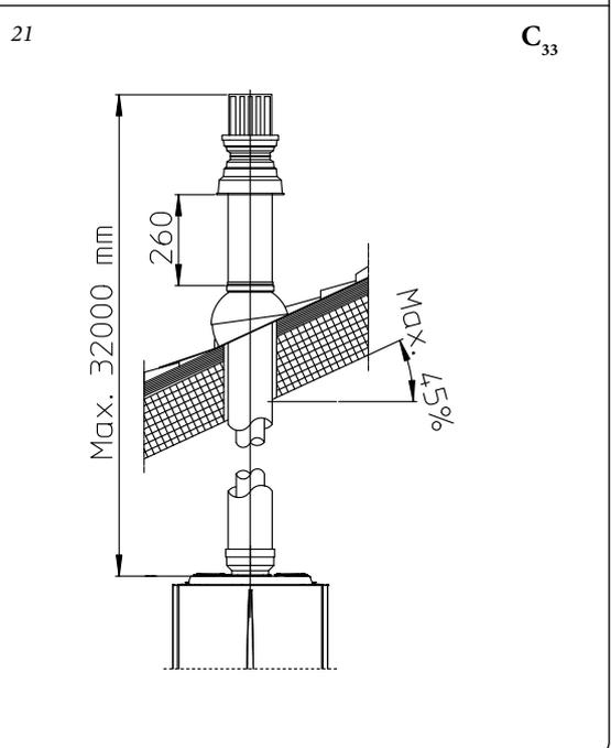
**1.15 INSTALLAZIONE KIT SEPARATORE. Configurazione tipo C a camera stagna e tiraggio forzato.**
