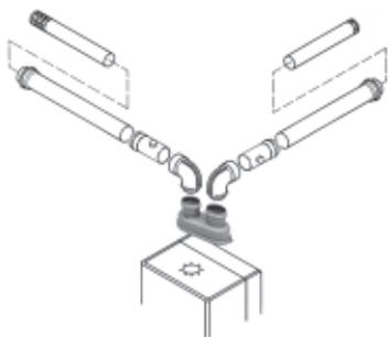
L'installazione di una curva nel collegamento della caldaia al camino crea una perdita di pressione.
