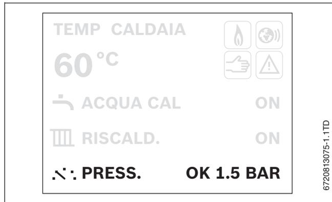
Fig. 5 Lettura della pressione d'esercizio
