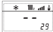
30. Visualizzazione valore temperatura sonda solare con schedino solare
