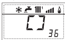
40. Visualizzazione valore % comando pompa PWM
