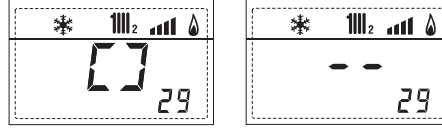
30. Visualización valor de la temperatura de la sonda solar S1 con tarjeta solar INSOL
