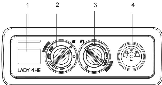
1 Visualizzatore digitale che segnala la temperatura di funzionamento e i codici anomalia
