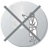
È vietata qualsiasi operazione di pulizia, prima di aver scollegato la caldaia dalla rete di alimentazione elettrica po-
