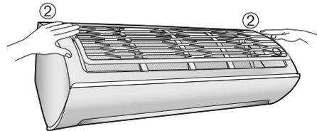
3. Per fissare definitivamente il filtro all'unità interna occorre premerne la parte inferiore. ③④⑤
