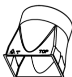
Raccordo piatto da posizionare tra la bocca di espulsione dell'aria e il tubo flessibile
