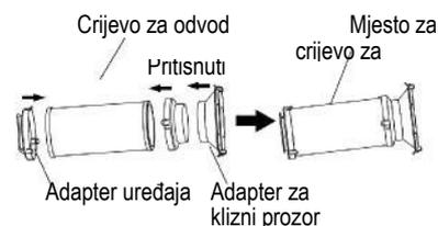
Drugi korak: postavljanje crijeva za odvod na uređaj. Umetnite crijevo za odvod u otvor za zrak uređaja slijedeći smjer strelice.
