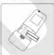
Sostituire le batterie
