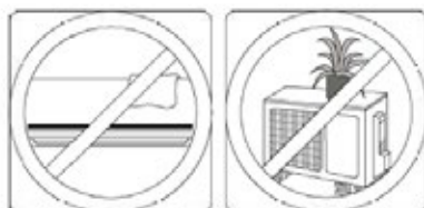
Verifica di eventuali ostruzioni delle prese o degli scarichi dell'aria.
