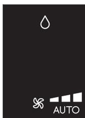
È ideale per ridurre l'umidità degli ambienti (stagioni intermedie, locali umidi, periodi di pioggia, ecc.). Per questo tipo di utilizzo, l'apparecchio deve essere predisposto nello stesso modo previsto per la modalità condizionamento, ovvero con il tubo di scarico aria (B2) applicato all'apparecchio per permettere lo scarico dell'umidità
