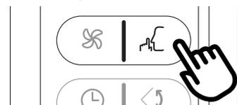
Con l'attivazione di questa funzione, la rumorosità dell'apparecchio viene ulteriormente ridotta. Per attivarla, premere il tasto SILENT (D7) del telecomando. Il display visualizza il relativo simbolo (C12).
