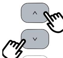
È possibile visualizzare la temperatura in °C o °F. Per cambiare l'unità di misura della temperatura, sfiorare contemporaneamente i tasti di aumento  $\wedge$  (C3) e diminuzione  $\vee$  (C4) per circa 10 secondi.
