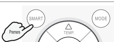
Per i modelli di tipo split, come ad esempio i condizionatori da parete o alcuni da pavimento, la loro modalità di funzionamento e la temperatura impostata devono essere determinate in base alla temperatura interna.
