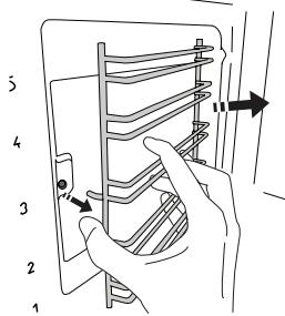
• **Per riposizionare le griglie laterali**, avvicinarle alla cavità e inserire dapprima i due perni interni nelle proprie sedi. Avvicinare quindi alla propria sede la parte esterna, inserendo il sostegno e premendo con decisione verso la parete della cavità per assicurare il fissaggio della griglia laterale.
