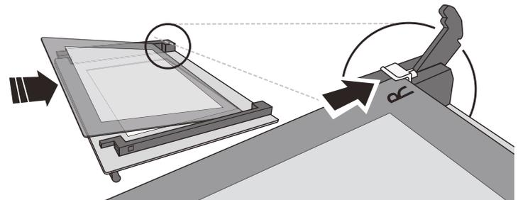
**4.** Rimontare il profilo superiore: un clic indica il corretto posizionamento. Verificare che la tenuta sia salda prima di rimontare la porta.
