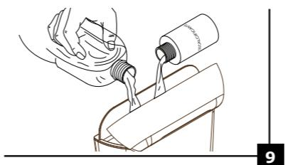
Prima di procedere, verificare che nell'alloggiamento (3) non sia inserita la capsula ed abbassare completamente la leva. Riempire il serbatoio con acqua potabile ed inserire il prodotto decalcificante seguendo attentamente le istruzioni del produttore. Si raccomanda di utilizzare solo soluzioni decalcificanti specifiche per macchine da caffè espresso; l'uso di prodotti non idonei può danneggiare la macchina.
