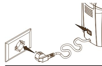
Collegare la macchina alla presa della corrente elettrica, seguendo le indicazioni di riportate nella sezione 'Avvertenze' a pag. 5. Accendere la macchina tramite l'interruttore posteriore.
