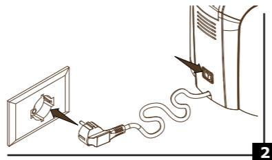
Die Maschine an die Steckdose anschließen, wie im Abschnitt "Hinweise" auf Seite 35 angegeben. Schalten Sie die Maschine mithilfe des Schalters an der Rückseite ein.
