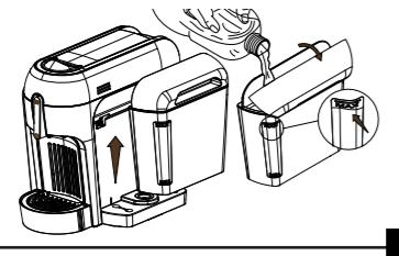
Bei vom Strom getrennter Maschine den Tank entnehmen und mit Trinkwasser nicht über die Markierung MAX hinaus füllen.
