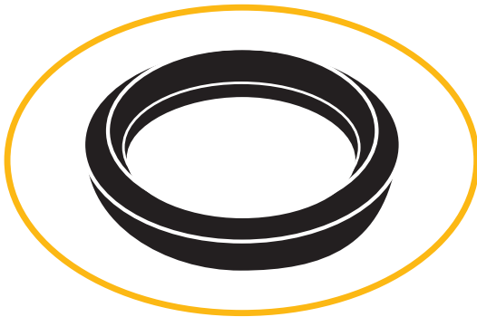
Guarnizione capsula. Capsule gasket.
