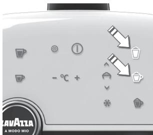
**4. Du kan ställa in maskinen så att den anpassas till kranvattnets hårdhetsgrad.** Håll in knapparna stor Cappuccino och Latte samtidigt under mer än tre sekunder för att gå till läget där du kan ange vattnets hårdhetsgrad. Knappen liten Cappuccino blinkar snabbt vilket indikerar att "high water hardness" har valts (standardinställning).
