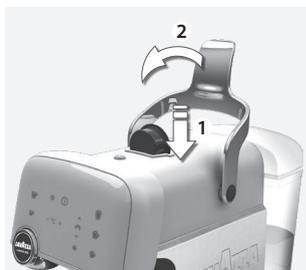
**1. Lyft kapselluckan, sätt i en kapsel i utrymmet.** Stäng kapselluckan och tryck på knappen för Espresso eller Caffè Crema. När kaffet är färdigt, lyft kapselluckan och kapseln faller ner i behållaren för använda kapslar.
