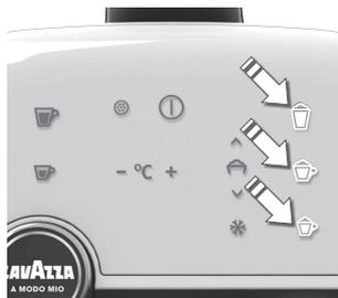
**2. Warm schuim maken:** Druk op de knop voor Cappuccino, Grote Cappuccino of Latte. De machine begint met het opschuimen van de melk. Het opschuimen stopt automatisch zodra de melk klaar is. U kunt ook handmatig stoppen door nogmaals op dezelfde knop te drukken. *Geschatte tijd voor warme, schuimende melk is 75 seconden voor Cappuccino, 90 seconden voor een grote Cappuccino en 110 seconden voor Latte.*
