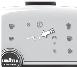
**2. Temperatuurselectie.** Voordat u op de koffie-knop drukt, kunt u met de "°C"-knop kiezen tussen twee verschillende koffietemperaturen: standaard of lagere temperatuur. De standaardtemperatuur wordt aangegeven met een "+", een lagere temperatuur wordt aangegeven door "-".
