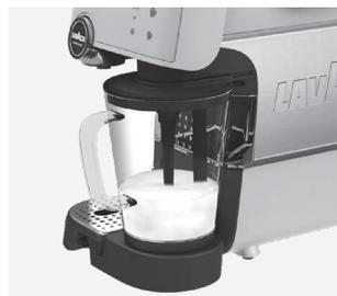
**3. Koud schuim maken:** Houd de knop voor Cappuccino, Grote Cappuccino of Latte langer dan 3 seconden ingedrukt. De indicator voor koude schuimende melk (sneeuwvlok) beginnen te knipperen en alleen de garde wordt geactiveerd (er komt geen stoom uit het stoompijpe). Het opschuimen stopt automatisch zodra de melk klaar is. U kunt ook handmatig stoppen door nogmaals op dezelfde knop te drukken. *Geschatte tijd voor koude schuimende melk is 45 seconden.*
