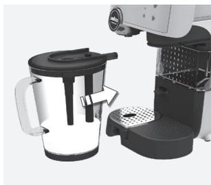
**1. Melkschuim maken voor Cappuccino en Latte:** Vul het melkreservoir met verse melk (standaard koelkasttemperatuur van 4-8 graden) precies op het niveau van de lijn voor Cappuccino, Grote Cappuccino of Latte (niet vullen onder het Cappuccino-niveau of boven de Latte-lijn). Plaats het deksel op het melkreservoir en schuif deze vervolgens terug aan de rechterkant van de lekbak.
