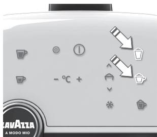
**4. È possibile impostare la macchina in base alla durezza dell'acqua del rubinetto.** Per accedere alla modalità di modifica della durezza dell'acqua, tenere premuti i pulsanti Cappuccino e Latte contemporaneamente per più di 3 secondi. Il pulsante Cappuccino Italiano lampeggia velocemente per indicare che è stata selezionata la "durezza alta" (impostazione predefinita).
