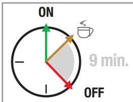
Die Maschine wird eingeschaltet und ein oder mehrere Kaffees werden erzeugt. Nach **9 MINUTEN**, nach der letzten Kaffeeausgabe schaltet sie sich automatisch ab.
