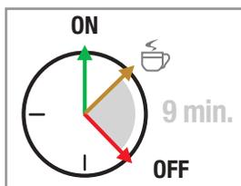
Vs. ha encendido la máquina y ha hecho uno o varios cafés. La máquina se para automáticamente después de 9 MINUTOS del último café.
