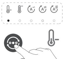
**Режим на ниска производителност:** Когато е в режим на ниска производителност, вашето устройство ви осигурява лек и комфортен топъл бриз.
