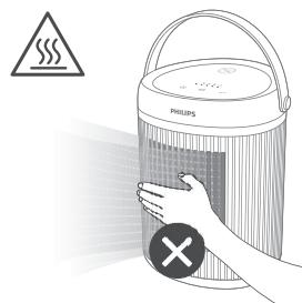
Undgå at røre ved luftudtaget, da det kan være varmt.
