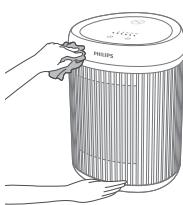
A por lerakódásának megelőzése érdekében rendszeresen tisztítsa meg a fűtőegység külsejét.
