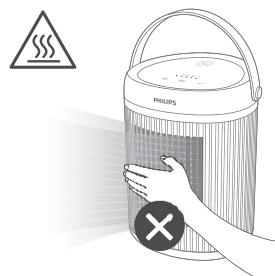
Unngå å berøre luftuttaket da det kan være varmt.
