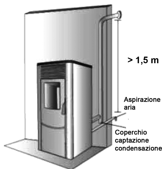
fig 6: installazione di uscita di fumi esterna (SCONSIGLIATA) che si dovrà realizzare di conformità con le norme
