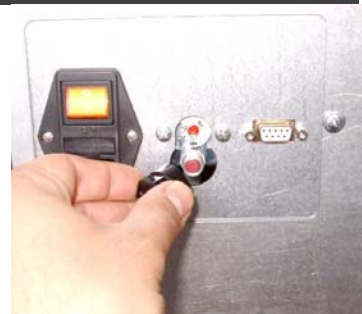
Figura 7 - Pulsante di ripristino sonda a bulbo
