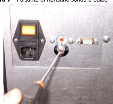
Figura 8 - Come ripristinare il termostato a bulbo una volta che la stufa è fredda.
