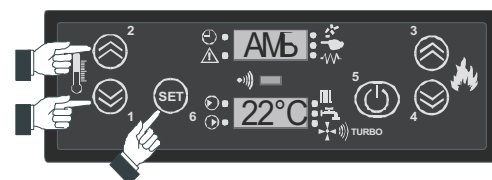
Settaggio temperatura dell'ambiente
