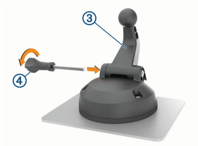
6 Inserire la vite a testa zigrinata ④ nel supporto e serrarla per fissare il braccio del supporto a sfera.
