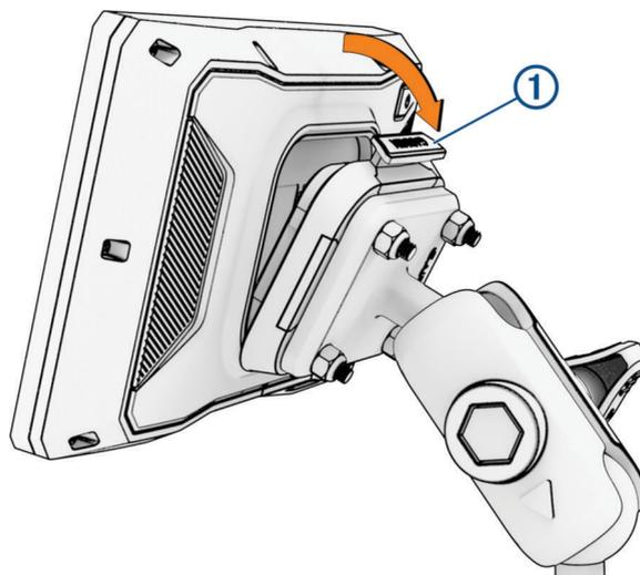
2 Premere la parte superiore del dispositivo in avanti finché non scatta in posizione.
