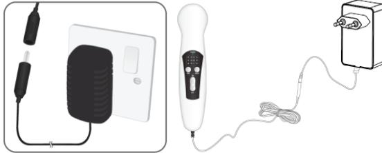
2. Portare l'interruttore in posizione **ON**: il led di accensione (sotto la scritta POWER) si accenderà, mentre gli altri sei inizieranno ad illuminarsi alternamente e la testina inizierà a vibrare segnalando che il dispositivo è entrato automaticamente in modalità preriscaldamento. Quando la temperatura preimpostata è raggiunta (dopo circa 3 minuti) i sei led lampeggeranno tutti assieme 5 volte, quindi il dispositivo entrerà in standby.
