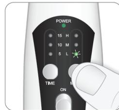
5. Selezionare il tempo di terapia premendo più volte il tasto **TIME**: si illumineranno in sequenza i led relativi ai 5-10-15 minuti di terapia ed il dispositivo inizierà a funzionare. Impostato il tempo, il dispositivo inizierà il trattamento automaticamente.
