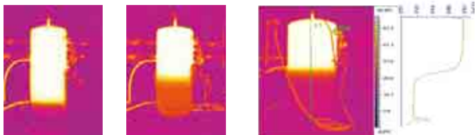
Sequenza di immagini termografiche della stratificazione dell'accumulo grazie all'innovativo Stratificatore a Labirinto brevettato Cordivari.
