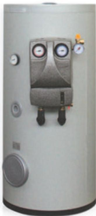
Bollitore in acciaio al carbonio vetrificato secondo normativa DIN 4753 dotato di doppio scambiatore fisso. L'isolante esterno è costituito da calotte in PU rigido amovibili e finitura con ABS colore grigio RAL 9006. A corredo un gruppo di pompaggio per impianto solare pre-assemblato dotato di pompa, regolatore di flusso, valvola di sicurezza e valvole con termometri.
