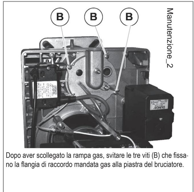
Dopo aver scollegato la rampa gas, svitare le tre viti (B) che fissano la flangia di raccordo mandata gas alla piastra del bruciatore.
