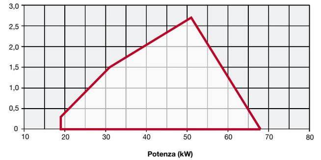
Contropressione in camera di combustione (mbar)
