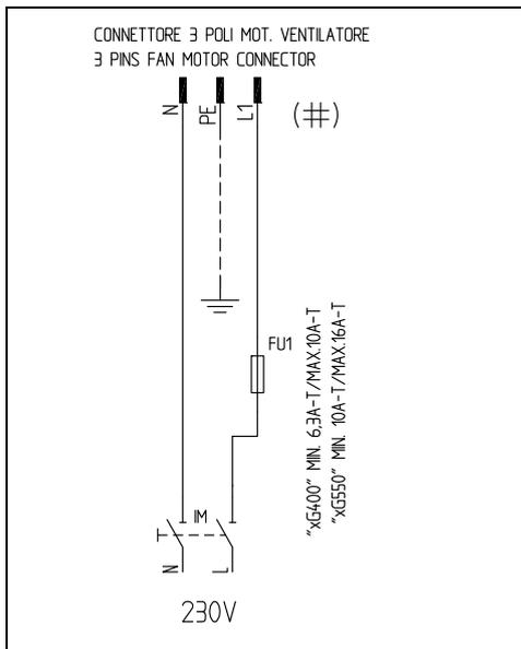
Fig. 39 - Connettore 3 poli motore elettrico per EM42
