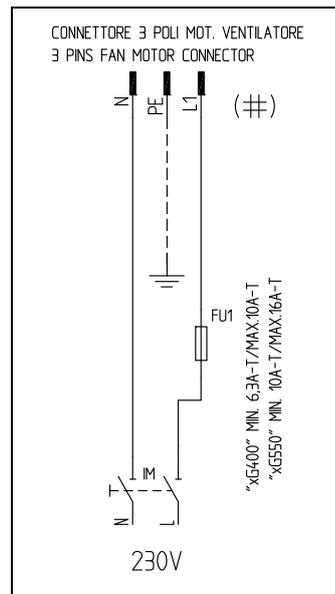
Fig. 37 - Connettore 3 poli per motore elettrico **EM42**
