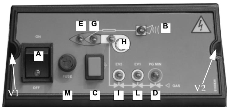
Fig. 49 - Pannello di controllo del bruciatore
