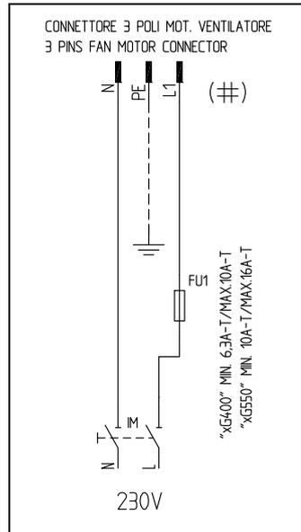
Fig. 35 - Connettore 3 poli motore elettrico per **EM42**
