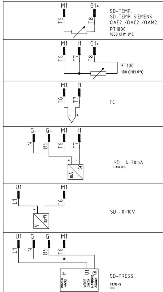
Fig. 40 - Connettore a 7 poli per collegamento sonde
