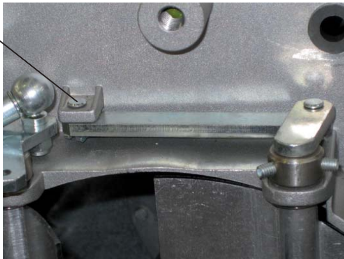
F Vista della serranda destra bloccata
