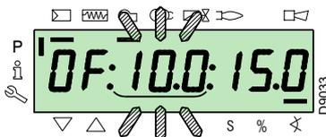
Per il servomotore dell'aria, tenere premuto il tasto "A" (la posizione in gradi lampeggia) e premere i tasti "+" o "-" per incrementare o diminuire il valore.
