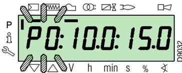
Per il servomotore del combustibile, tenere premuto il tasto "F" (la posizione in gradi lampeggia) e premere i tasti "+" o "-" per incrementare o diminuire il valore.
