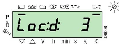
Il display visualizza alternativamente un codice ed una diagnostica di errore, che non porta il sistema in sicurezza.
