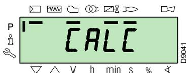
L'apparecchiatura calcolerà in automatico i punti da "P8" a "P2", distribuendoli in una retta. Essi sono teorici e devono essere verificati.
