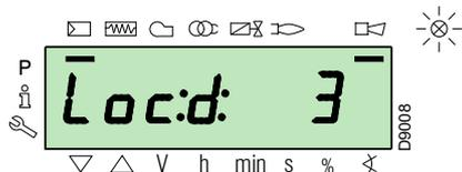
Per sbloccare premere il tasto "i/reset" per 1s: sul display appare "rESEt". Al rilascio del tasto scomparirà la segnalazione di blocco e si spegnerà la spia rossa. L'apparecchiatura è sbloccata.
