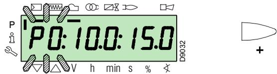
Accedere al Livello Parametri facendo riferimento alla "Procedura di accesso tramite password" a pag. 36. Il display visualizza il gruppo parametri 400.
