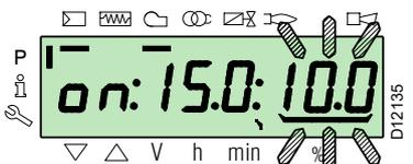
Selezionare un altro punto, oppure uscire premendo contemporaneamente i tasti "+" e "-" (ESC).
