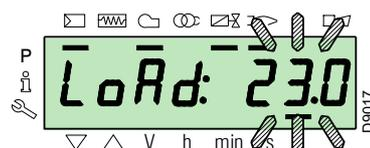
Per uscire dal modo manuale premere contemporaneamente i tasti "+" e "-" (ESC) per 3 secondi: il bruciatore funzionerà in automatico e la potenza dipenderà dal termostato/presostato di regolazione (TR).
