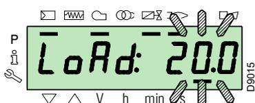
Rilasciando il tasto "F" appare la visualizzazione standard con la percentuale di carico attuale lampeggiante: questo significa che il bruciatore sta funzionando in manuale (viene esclusa qualsiasi regolazione esterna, sono attivi solo i dispositivi di sicurezza).
