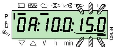
Per la regolazione della velocità dell'inverter (espressa in % e cioè 50 Hz = 100 %), tenere premuti contemporaneamente i tasti "F" e "A" la posizione in percentuale lampeggia e premere i tasti "+" o "-" per incrementare o diminuire il valore.
