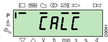
L'apparecchiatura riporterà automaticamente gli stessi valori impostati nei punti "P0" e "P1" ai punti da "P2" a "P8".
