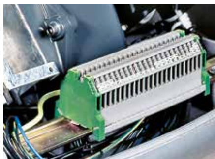
Esempio della morsettieria per collegamenti elettrici dei modelli RS 70-100-130-190-250/M.
