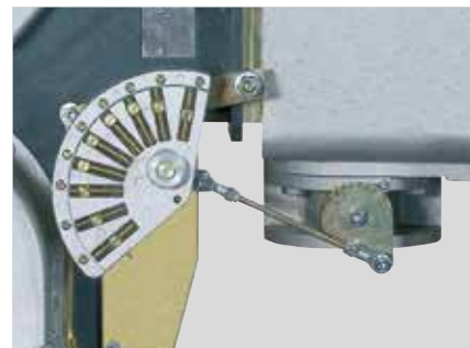
Esempio della camma a profilo variabile su bruciatori RS 250/M Z.
