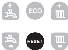
Il tasto di reset serve per riavviare la caldaia in caso di malfunzionamento. In caso di malfunzionamento, viene visualizzata l'icona
