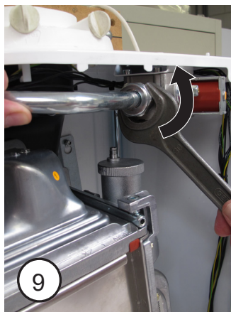
9. Svitare il raccordo della valvola gas;
