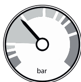
Fig.57 Manometro di caldaia
